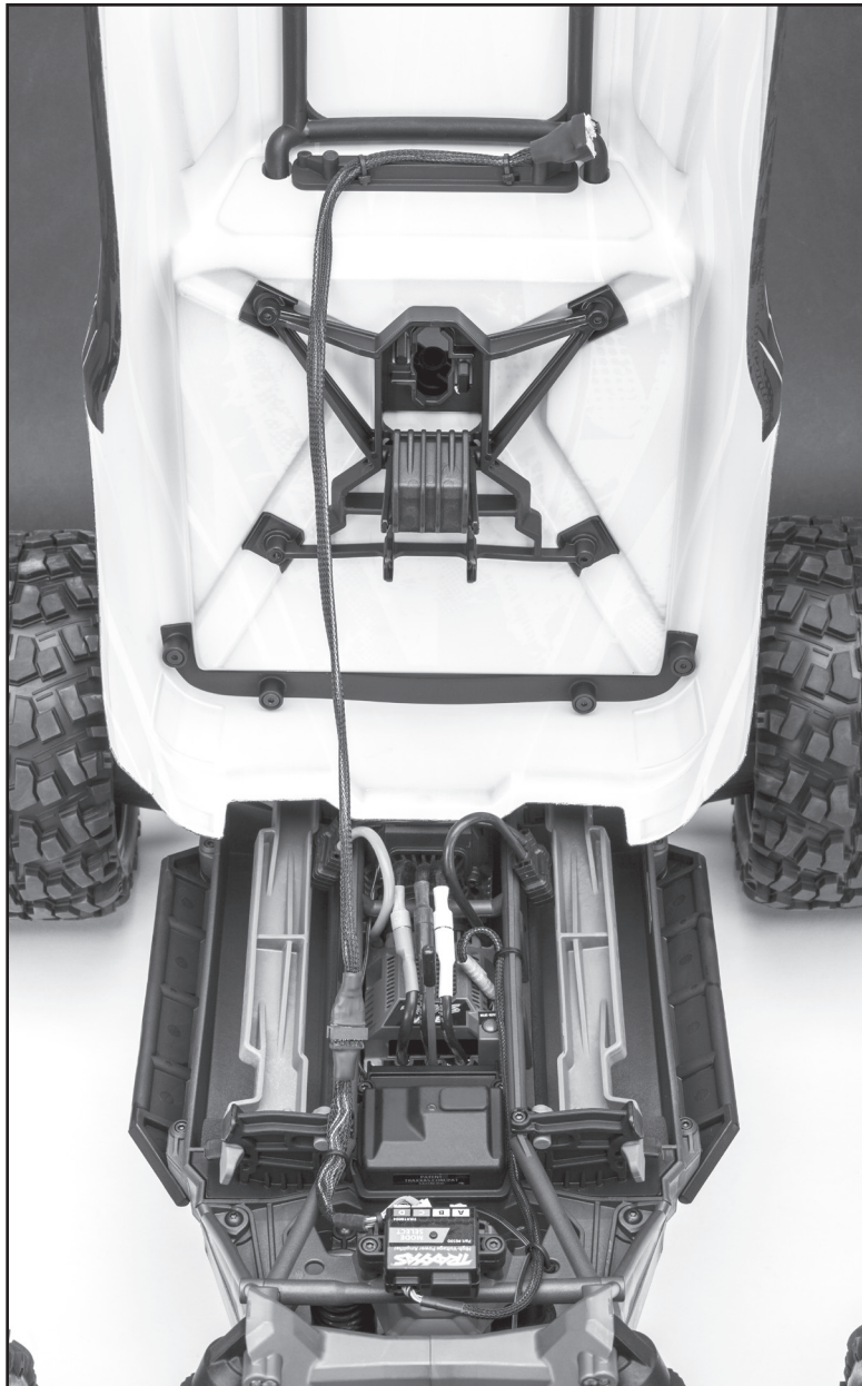
Arneses de extensión largos y cortos conectados para suministrar energía a las luces led
