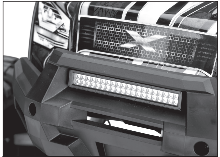
Barra de luces led del paragolpes delantero instalada
