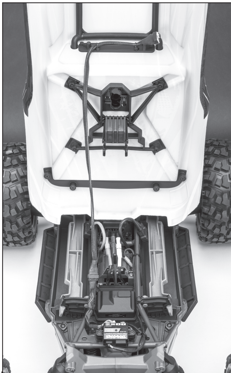
Faisceaux de rallonge court et long connectés pour alimenter les feux DEL
