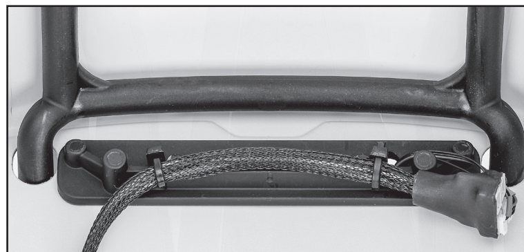
Câblage de la barre de feux arrière/long faisceau de rallonge installés sur le support de la barre de feux arrière
