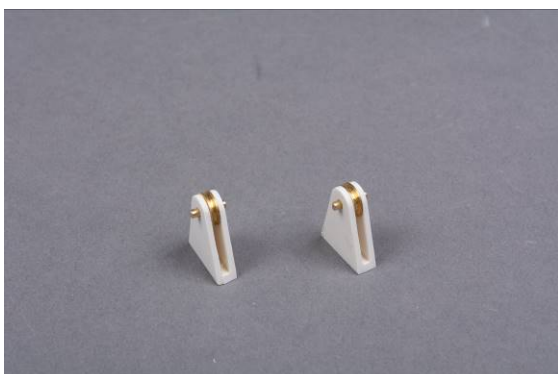
Abb. Rollenböcke fertig
