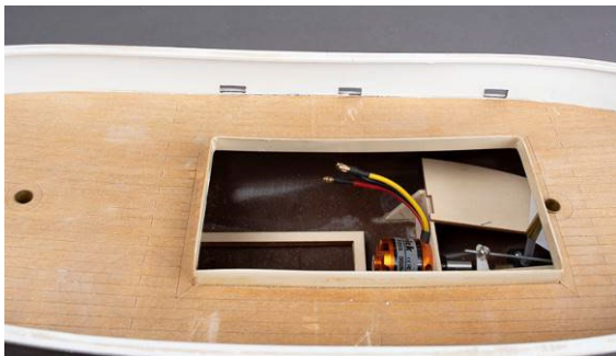
Abb. Speigaten hergestellt und Deck platziert
