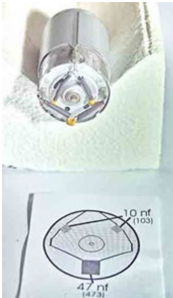
Abb. Motor entstören
