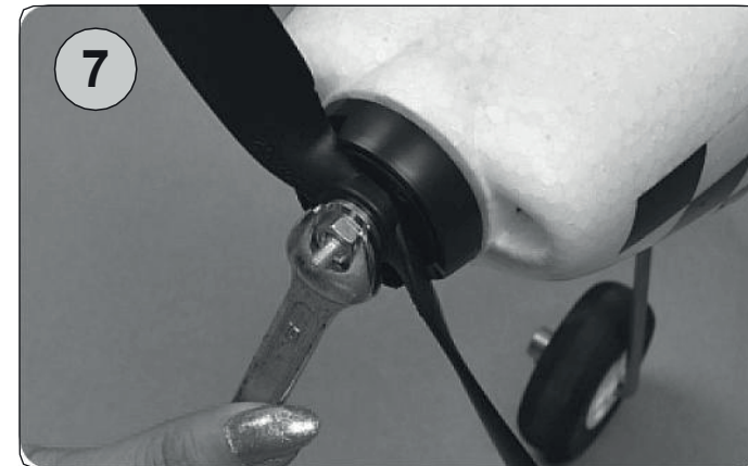
Bild 3 - 7 Setzen Sie den Luftschraubenmitnehmer auf die Motorwelle. Montieren Sie anschließend die Spinner-Rückplatte, die Luftschraube, Unterlegscheibe und Luftschraubenmutter. Ziehen Sie die Mutter sorgfältig fest, um ein Lösen der Luftschraube auszuschließen.
