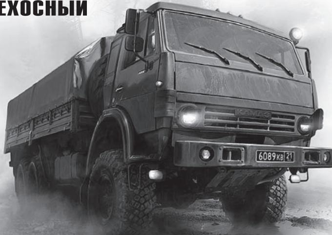
Автомобиль принадлежит к семейству «Мустанг», куда входят армейские грузовики высокой проходимости. Он является универсальным автомобилем с колесной формулой 6x6, предназначенным для перевозки военных грузов и личного состава, буксировки прицепов и буксируемой артиллерии, а так же установки различных систем вооруженных сил.
