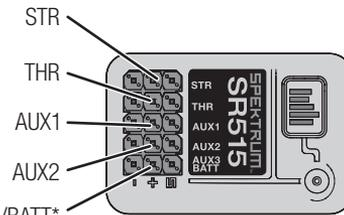
**\*WICHTIG:** AUX 3 auf SR515 teilt sich den Servo-Anschluss mit dem Akku. Am AUX-3-Anschluss ist ein Y-Kabel (SPMA3008) erforderlich, um alle 5 Kanäle mit einem Empfänger-Akku zu verwenden.
