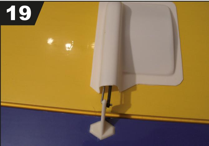
Die Schachtverkleidungen werden mit tesaFilm oder doppelseitigem klebeband über die Öffnungen geklebt, sodass die Servos zugänglich bleiben.
