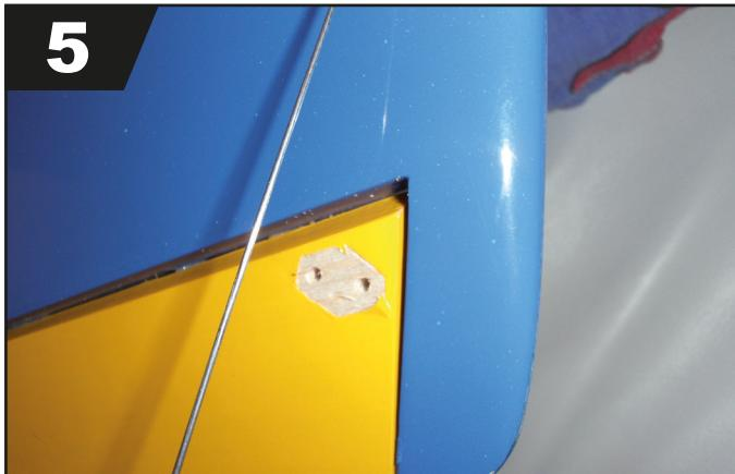
Anschließend wird die Seitenruderanlenkung montiert. Dabei wird das Ruderhorn fluchtend zum Bowdenzug mit leichtem Druck gegen das Seitenruder gedrückt, um die Bohrlöcher zu markieren, welche dann mit einem 2mm Bohrer gebohrt werden können.
