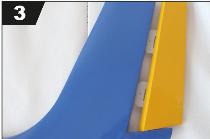
Collez les charnières à la gouverne de dérive en utilisant de la colle Epoxy 5 minutes. Alignez la gouverne par rapport au fuselage et coller les charnière à l'aide de colle Epoxy 5 minutes.
