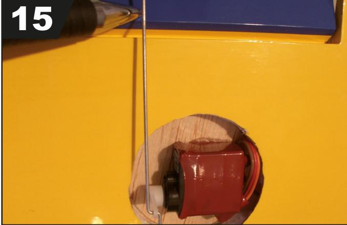
Connectez les tringleries aux servos d'ailerons. Marquez la position des tringleries.
