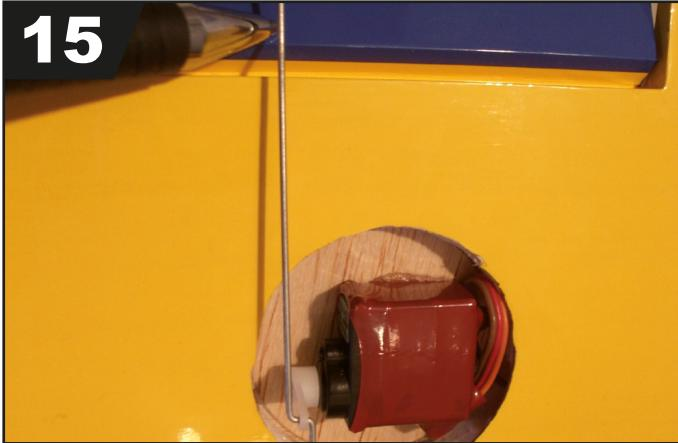
Die Querrudergestänge werden angebracht und zum Querruder ausgerichtet. Die position wird markiert.
