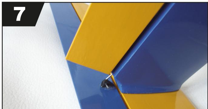
Découpez dans la gouverne de profondeur une fente rectangulaire afin d'y insérer le guignol de profondeur, effectuez le collage à l'aide de colle Epoxy.
