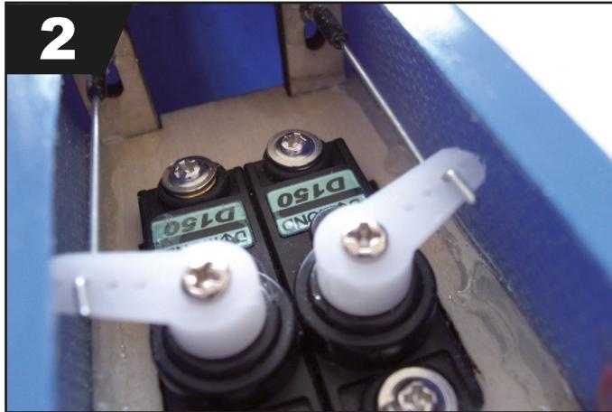
Die Servos werden an den Empfänger angegeschlossen und zentriert. Mit einer Spitzzange wird in das Ende des Bowdenzug-Drahtes ein „Z“ gebogen, welches anschließend durch die Servohörner gesteckt wird. Dann werden diese befestigt.
