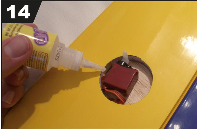
Die Servos werden über den Sender wieder in neutralstellung gebracht und das Servohorn aufgeschraubt. Anschließend werden sie anhand der Schachtverkleidungen ausgerichtet und mit Sekundenkleber in die Flächen einge- klebt.
