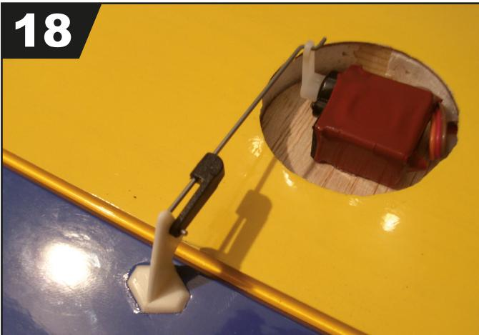
Die Sicherungshülsen werden über die Gestänge gesteckt und die Gestänge in neutralstellung abgelängt. Anschließend werden die Sicherungshülsen über die Drahtenden gesteckt.
