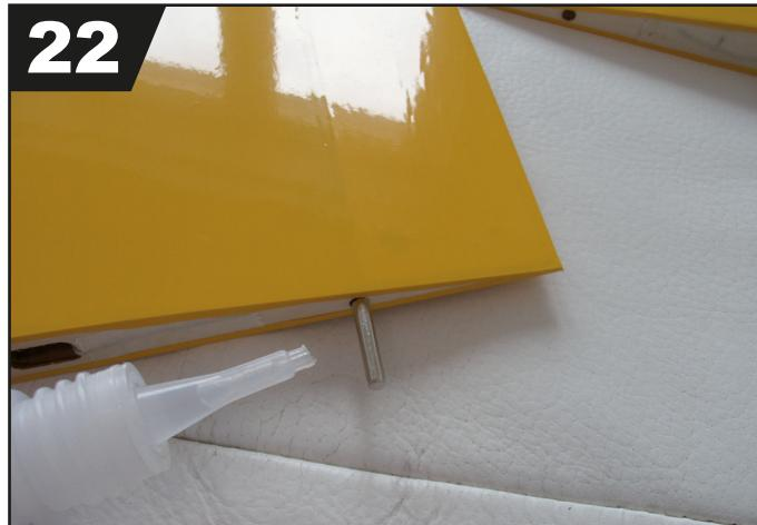
Im letzten Bauabschnitt wird die Flächenzentrierung sowie der Flächenverbinde aus Kohlefaser in EINE HÄLFTE der Fläche eingeklebt, sodass nichts verloren gehen kann.
