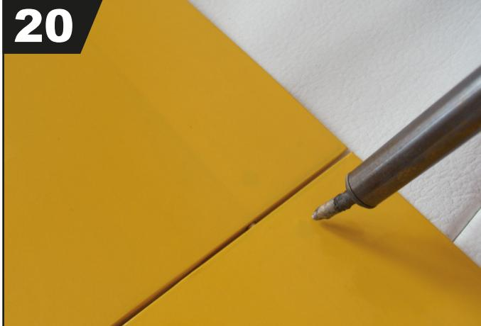
Utilisez un scalpel ou un fer à souder pour ouvrir les trous de fixation d'ailes. Collez les renforts en aluminium.
