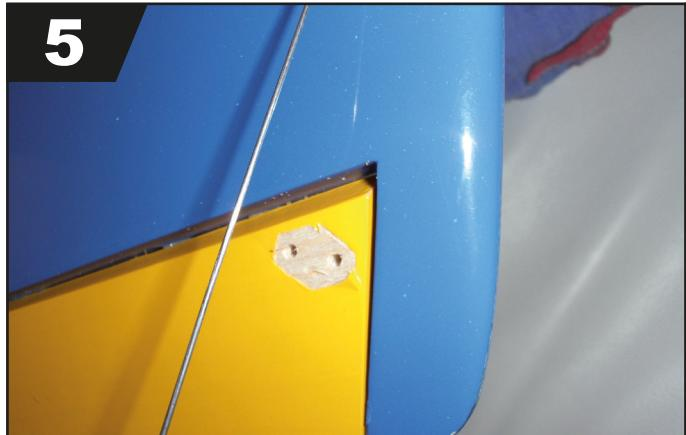
Appuyez légèrement sur la tringlerie de dérive pour l'aligner par rapport au guignol et marquez la position du guignol. Utilisez un foret de 2mm pour percer les trous de fixation et retirez la platine du guignol avant de le coller à la colle Cyano.
