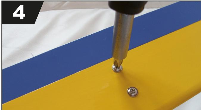
Es folgt die Montage des Höhenruders, wobei die Befestigungsschrauben mit Loctite gesichert werden sollten.
