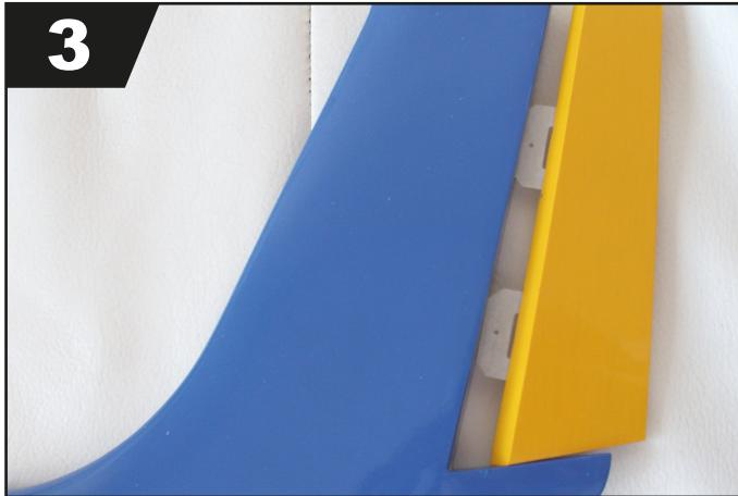
Anschließend werden die Scharniere des Seitenruders mit 5 Min. Epoxy im Rumpf und Ruder verklebt und am Rumpf ausgerichtet.
