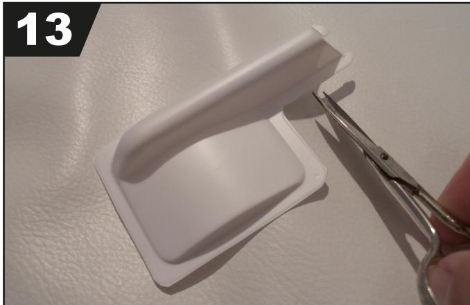
Utilisez des ciseaux à Lexan pour ajuster les carénages des servos.
