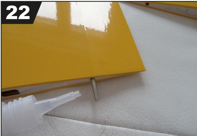
Collez le téton d'anti-rotation et la clé d'aile dans une des ailes afin d'éviter leur perte.
