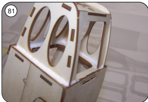
Satt mit Holzleim vermuffen.
