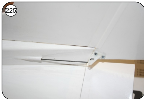
225 Z-Gestänge für Höhen- und Seitenruder einschieben und im vorderen Bereich zum Servo hin entsprechend kürzen. Ruderhörner auf das Z-Gestänge auffädeln und an den Rudern verschrauben.
