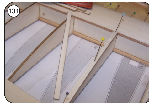
131 Rippenaufleimer auf der Tragflächenoberseite einpassen und aufleimen.
