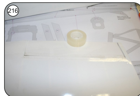
Querruder in die Tragfläche einsetzen und auf der Oberseite mit Scharnierklebeband ankleben.
