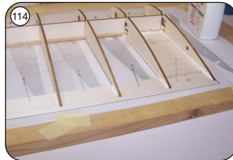
114 Alle Klebestellen nachträglich mit Holzleim vermuffen.
