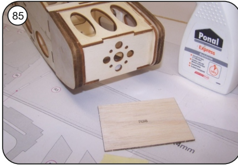
Obere Beplankung für Motorträger R38 und untere Beplankung für Motorträger R38u einpassen und mit Holzleim einkleben.
