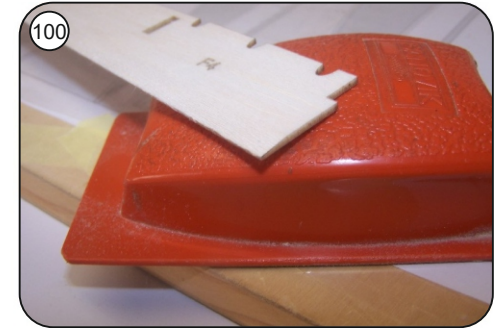
100 Hinterkante von Beplankung F4 für die spätere Verklebung schräg anschleifen. ( s. Profilschnitt )
