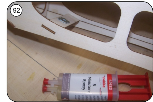
Zm Einbau der Einschlagmutter für die Tragflächenverschraubung diese mit einer passenden Gewindeschraube (M6) und Unterlegscheiben in den Holzsteg R16/R17 einziehen und von der Unterseite mit Epoxy sichern.
