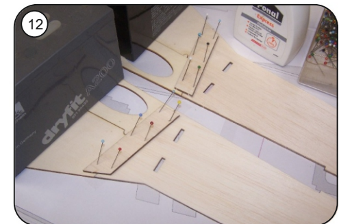
10 Verstärkungen R4 auf die Rumpffinnenseite der Stosskante von R1-R2 und R3 kleben, dabei mit Gewichten und Nadeln fixieren. An Ober- und Unterkante jeweils etwa 4mm Spalt für die später aufzuleimenden Balsaleisten 4x4mm lassen.
