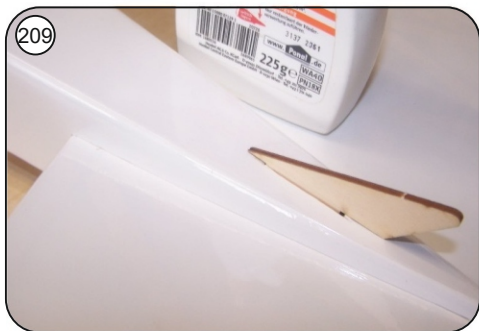
Höhenleitwerk ausrichten und einkleben, dabei auch den Hecksporn einkleben.
