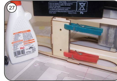
Fahrwerksträgerplatte R12 einkleben, Aufdoppelung der Fahrwerksträgerplatte R11 mit reichlich Holzleim einkleben.
