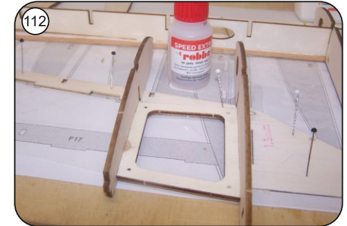
112 Servomontagebrett F12 in die Rippen F11 und F12 einkleben.
