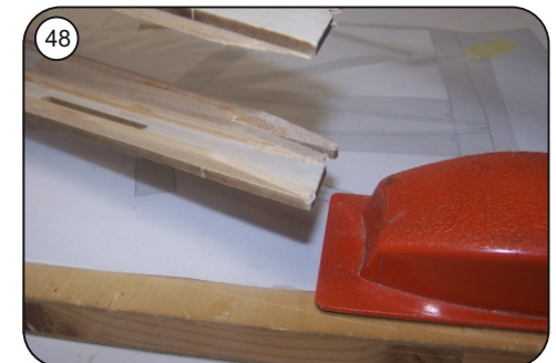
48 Balsaleisten am Rumpffende schräg verschleifen, Schnitt s. Bauplan.
