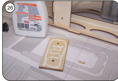
Fahrwerksträgerplatte R12 einkleben, Aufdoppelung der Fahrwerksträgerplatte R11 mit reichlich Holzleim einkleben.
