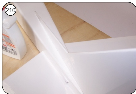
Seitenleitwerk rechtwinklig ausrichten und ebenfalls einkleben.
