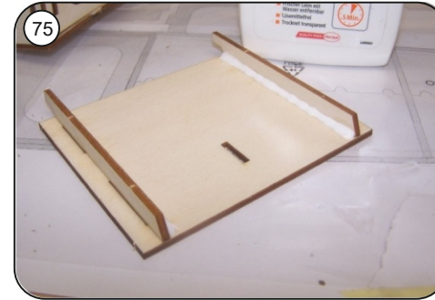
Stege R29 mit Sekundenkleber in den Akkudeckel R30 einkleben, nachträglich nur von der Innenseite mit Holzleim vermuffen.
