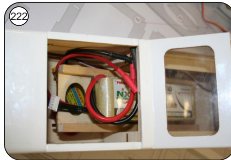
222 Akku und Akkurutsche mit Klettband ausstatten und probeweise einbauen. zusätzlich mit einem Zurrband sichern.
