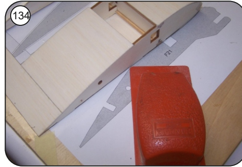
133 Bepunktungs- und Leistenüberstände an Wurzel- und Endrippe mit den Rippen bündig verschleifen.
