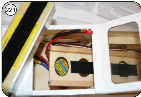
221 Regler und Motor verbinden und en Regler unter der Akkurutsche platzieren.
