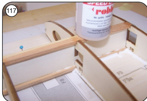
117 Zum fixieren der Verklebung des Holmgurtes während des Trocknens an den Rippentaschen mit Sekundenkleber heften.
