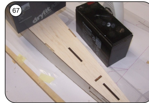
66 Klebestellen für die Rumpfrückenbeplankung R21 satt mit Holzleim einstreichen, R21 auflegen und bis zum Durchtrocknen mit Gewichten sichern.
