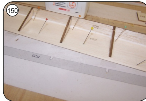
150 Klebekante F22 zu F25 mit Holzleim vermuffen.
