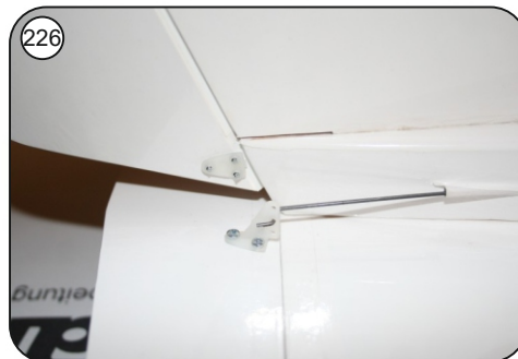
225 Z-Gestänge für Höhen- und Seitenruder einschieben und im vorderen Bereich zum Servo hin entsprechend kürzen. Ruderhörner auf das Z-Gestänge auffädeln und an den Rudern verschrauben.
