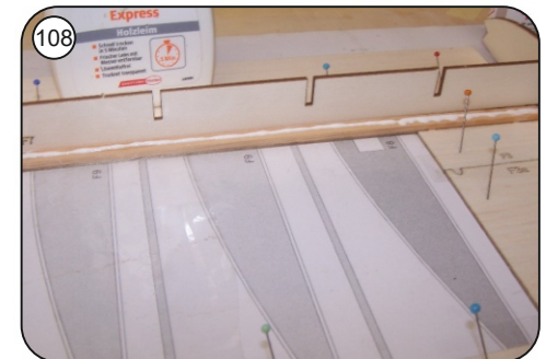
108 Holmgurt in der Länge von Kammholz F7 satt mit Holzleim einstreichen.
