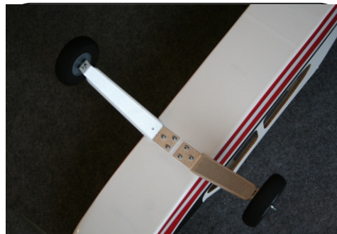
Fahrwerksschenkel mit den Schrauben M3 am Rumpf verschrauben
