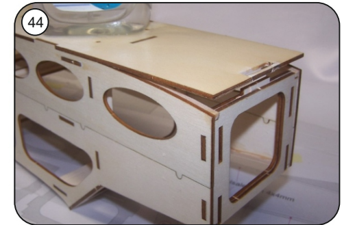
44 Vorderen Bereich der Rumpfbodenbeplankung von aussen leicht anfeuchten.
