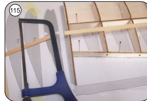
115 Oberen Holmgurt Kiefer 8x3mm auf Länge zuschneiden und mit Holzleim auf dem Kammholm verkleben.
