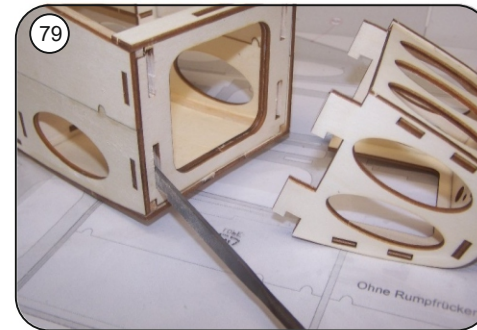
Fertigen Motorträger an den Rumpfkopf anpassen, Einsteckschlitz evtl. dabei etwas ausfeilen. Motorträger einhaken und an den Einsteckhaken mit Sekundenkleber sichern.
