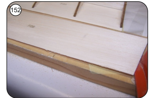
152 Hinterkante von oberer Beplankung F26 schräg anschleifen.
