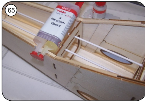
65 Klebestellen in den Spanten mit Epoxy verkleben.
