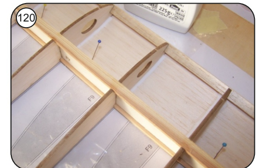
120 Von der Innenseite nachträglich mit Holzleim vermuffen.
