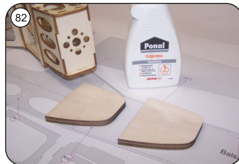
Je 2 Stck. Aufdoppelungsscheiben R36 rechts und links an den Motorträger ankleben. Die Höhe am fertigen Rumpf ausrichten.
