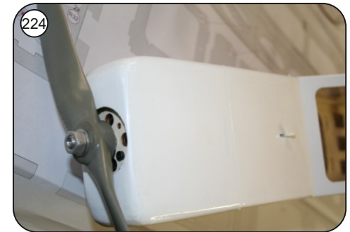
224 Luftschraube montieren u. Funktionsprobe unter Beachtung der Sicherheitsanweisungen durchführen.
