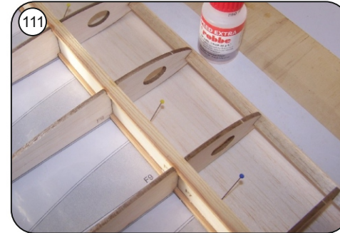
110 Holmgurt auf der gesamten Restlänge satt mit Holzleim einstreichen, Kammholzverlängerung an der Stossrippe einsetzen und die restlichen Rippen F9 einkleben.
