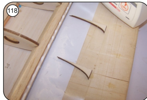
118 Nasenleiste Balsa 8x8mm einkleben, die Vorderkante von Beplankung F1 satt mit Holzleim einstreichen und mit den Formkeilen an jeder Rippe anheben und abstützen, Verbindung Rippen / Beplankung mit Sekundenkleber anheften.
