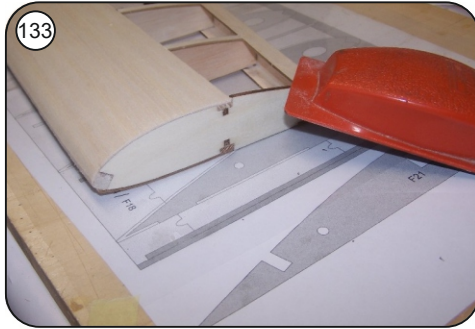
133 Bepunktungs- und Leistenüberstände an Wurzel- und Endrippe mit den Rippen bündig verschleifen.
