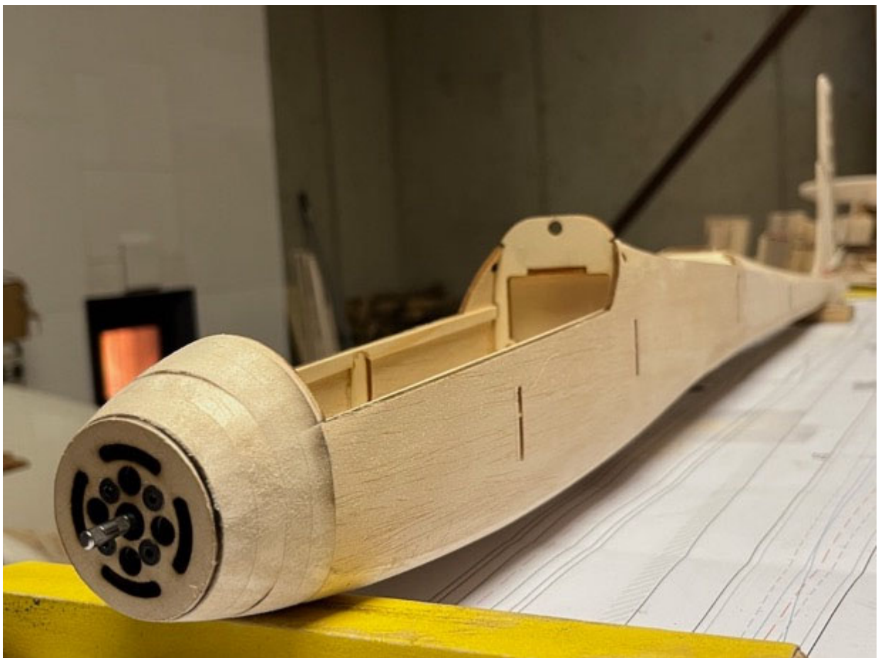
.. die Nase nach dem ersten Schleifdurchgang. Hier ist der Motorspant noch aus Sperrholz.
