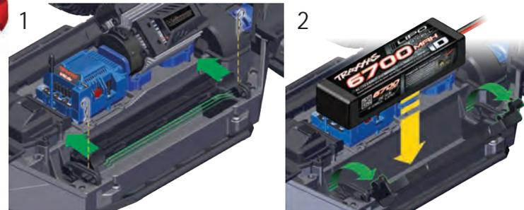
**Nota:** El compartimiento de la batería incluye separadores de espuma para alojar paquetes de baterías de 6700 mAh Traxxas 4s (pieza n.º 2890X). Cuando utilice los paquetes de baterías Traxxas de 5000 mAh 3s (pieza n.º 2872X), instale los separadores de paquetes de baterías sobre las sujeciones (simplemente encajan en su lugar). También tendrá que utilizar los bloques de separadores de espuma incluidos.
