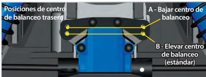
**Nota:** Si coloca los tirantes delanteros en la posición inferior (no estándar), entonces deberá voltear las bolas de pivote en la dirección. Las bolas de pivote exteriores salen de la caja en la posición inferior (A). Cuando se desplaza el centro de balanceo, deberá voltear la compensación (B).
