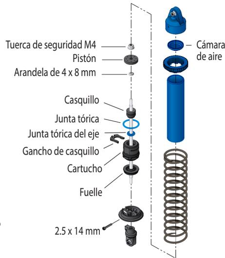
**Nota:** El nuevo cartucho debe ser ensamblado en el eje del amortiguador. NO intente ensamblar el cartucho por separado y deslizarlo sobre el eje. Esto puede dañar la junta tórica del eje y causar una fuga.
