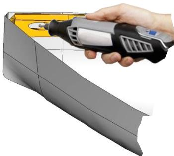
Im Bugbereich wird mit einer Minibohrmaschine das Loch für den Bugsriet vorsichtig aufgebohrt und gefeilt.
