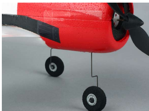
Tříkolé uspořádání podvozku s říditelným předovým kolem
