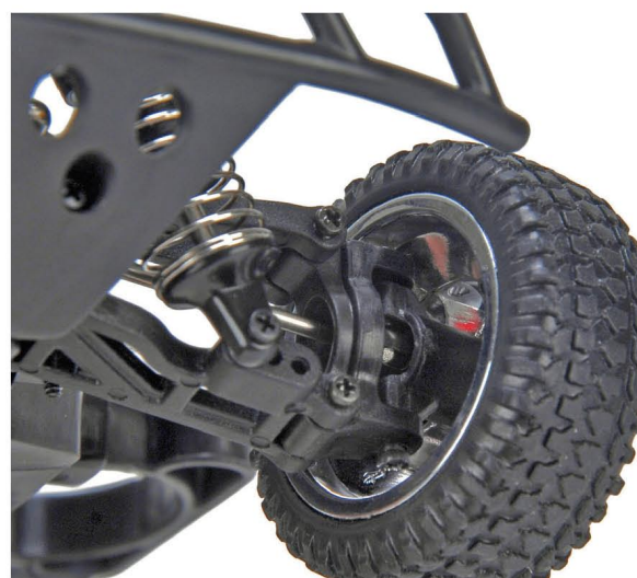
Nastavitelné pozice tlumičů
