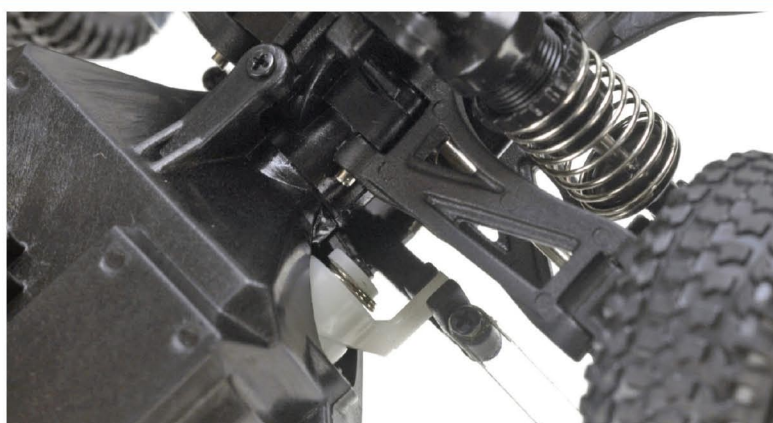
Servo saver ochrání servo řízení
