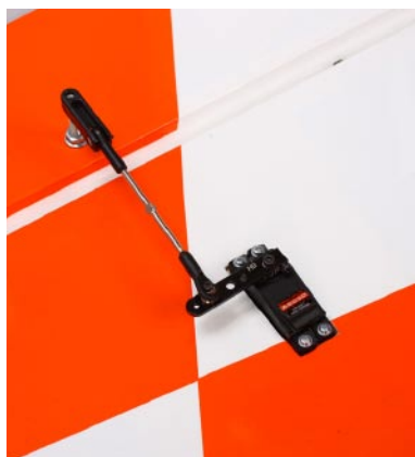
Nainstalované digitální serva Spektrum 5x A6030 High Torque (20kg)
