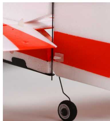
Spřažené řízení směrového kormidla a ostruhového kolečka
