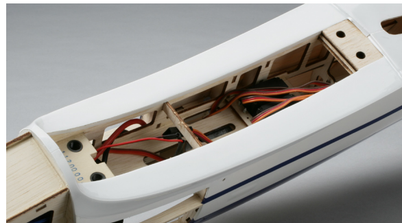
Montáž křídla pomocí 4 šroubů
