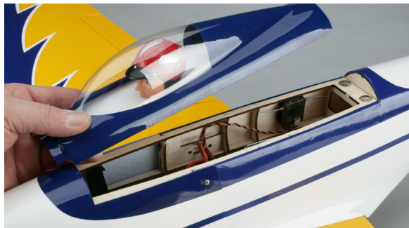
Rychlá výměna baterie díky magnetickému uzávěru
