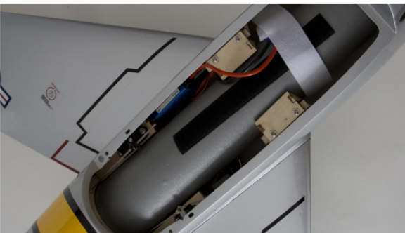
Velký kryt pro přístup k bateriím s magnetickým uzávěrem
