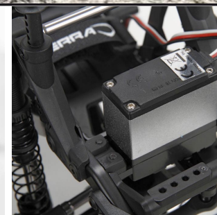
9 kg servo řízení s kovovými převody
