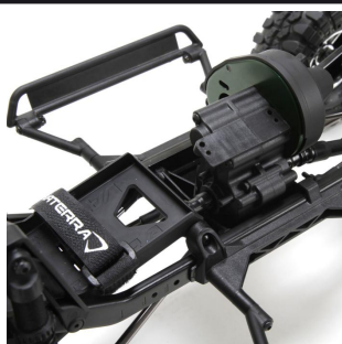
Pružné uložení desky na baterie nad přední nápravou.
