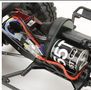
Výkonný motor Dynamite® Crawler 35T a Voděodolný regulátor Dynamite WP
