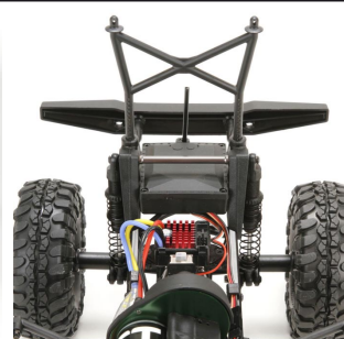
Pevná náprava, nastavitelný rozvor, nastavitelné pozice tlumičů
