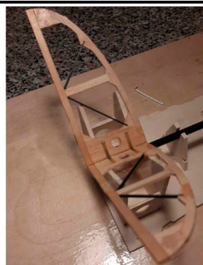
Konstrukce ocasních ploch je dřevěná, vyztužena uhlíkem.
