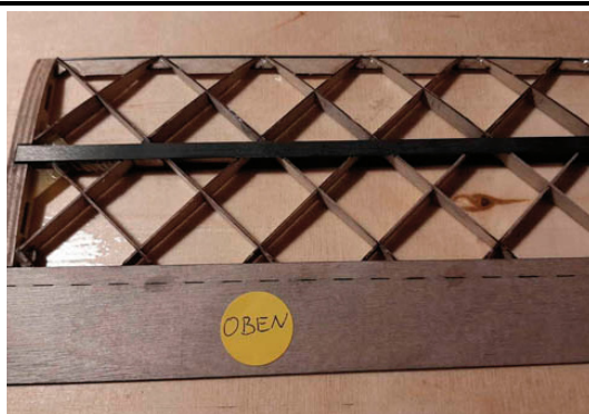
Pevná, lehká a tuhá diagonální konstrukce křídla. Křídlo má funkční křídélka a je dělené.
