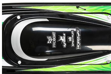
Kryt paluby má 4 upevňovací šrouby, pěnové těsnění kolem otvoru chrání před vniknutím vody do trupu lodi.
