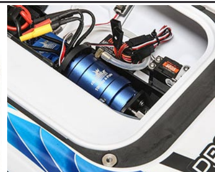
Lod' pohání výkonný střídavý vodou chlazený motor Dynamite 1900Kv 4T a vodou chlazený regulátor Dynamite 120 A.
