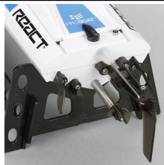
Nainstalované kormidlo řízení s vyvažovacími ploškami pro přesné řízení lodi v zatáčkách a na rovinách.
