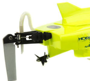
Pro řízení je nainstalováno mini servo řízení Dynamite. Loď má nainstalováno hliníkové kormidlo.
