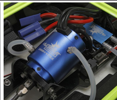
Lod' pohání výkonný střídavý vodou chlazený motor Dynamite 2000Kv 6T a vodou chlazený regulátor Dynamite 120 A.
