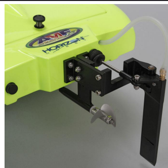
Lod' má nainstalováno hliníkové eloxované kormidlo. Lodní šroub je hliníkový 1.6" x 2.5".
