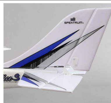
Na trup se položí výškovka, do ní se shora vloží čepy směrovky a zespodu se vše dvěma šrouby přitáhne ke trupu.
