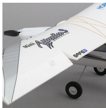
Model Mini Apprentice S má řízeny základní funkce, jako plyn, směrovku, výškovku a křídélka.
