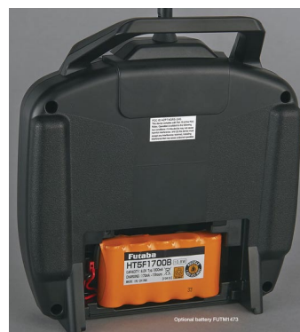
Vysílač lze napájet AA články nebo LiFe akumulátory
