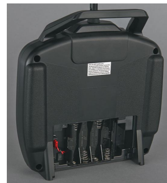
Vysílač lze napájet AA články nebo LiFe akumulátory
