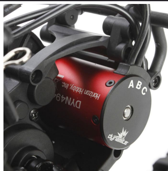
Nainstalovaný 4 pólový motor Dynamite® Tazer™ 3300Kv.
