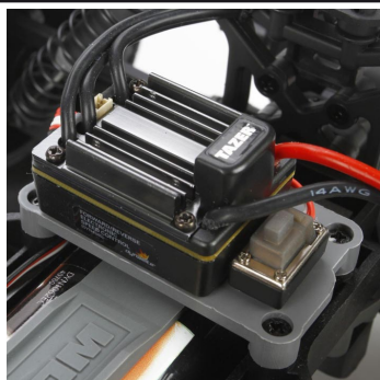
Nainstalovaný voděodolný střídavý regulátor Dynamite® Tazer™ 45A.
