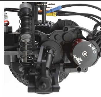
Motor je nainstalován za zadní nápravou, důraz je kladen na vyšší trakci.
