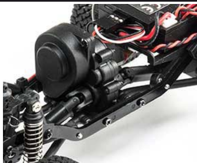
Motor s převodovkou má vysoký točivý moment pro jízdu v terénu. Hliníkové bočnice, 4-bodové zavěšení, výkyvné nápravy.
