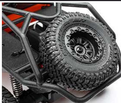
Náhon všech kol 4WD, pnemumatiky Falken Wildpeak M/T s funkční rezervou.
