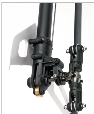
Ocasní rotor má vyvážené nainstalované listy, axiální ložiska, náhon ocasního rotoru řemenem.
