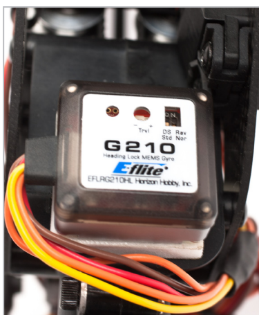
MEMS gyro E-flite® Micro G210HL a rychlé digitální servo S400G ocasního rotoru pro bleskovou reakci vyrovnávacího rotoru.
