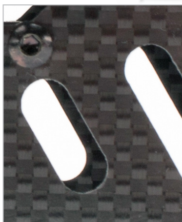
Extrémně tuhé a lehké uhlíkové bočnice mají při minimální hmotnosti vysokou tuhost, což je důležité při extrémní akrobacii.
