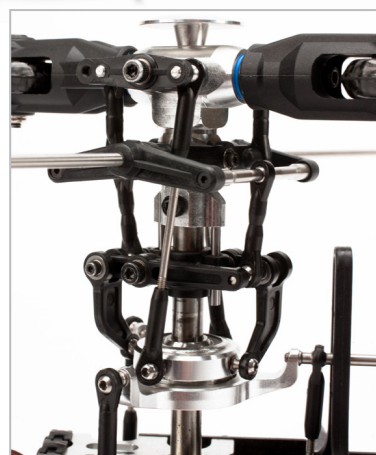
CNC hliníková rotorová hlava, CNC hliníková deska cykly, hlavní hřídel z kalené oceli a 3x kuličkové ložisko, uhlíkové symetrické rotorové listy.
