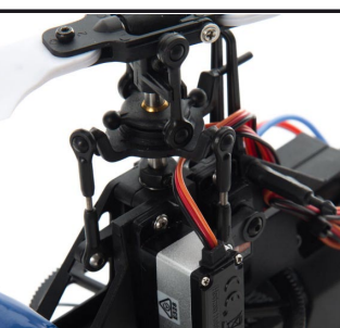
Cyklíku ovládají silná 9g serva s kovovými převody H3050 Sub-Micro Digital Heli MG.
