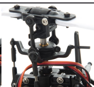
Nová konstrukce rotorové hlavy a cyklíky pro přesnější řízení.
