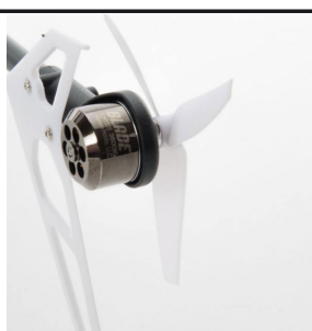
Model je poháněn novým hlavním střídavým motorem 3980Kv, ocasní motor je 3600Kv.
