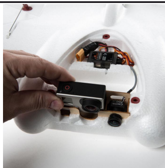
Kamera s širokoúhlým objektivem a vysokým rozlišením 700TVL CMOS. Volitelná kamera GoPro Hero 3, 4.
