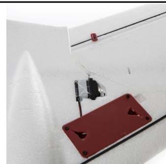
Digitální vysokorychlostní serva Spektrum H3050 Sub-Micro, s kovovými převody
