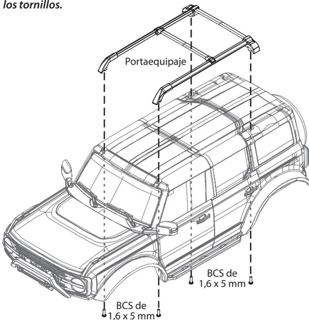
**B2.** Utilice un escariador de carrocería cónico para cortar cuidadosamente un orificio de 7 mm en la parte delantera del techo, tal como se muestra.
