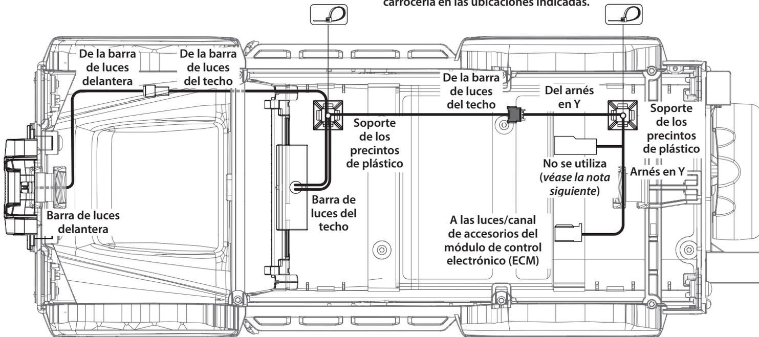
*Nota: Si el juego de luces de carrocería n.º 9784 se ha instalado previamente en la carrocería, enchufe el conector n.º 9784 en el arnés en Y incluido.*
