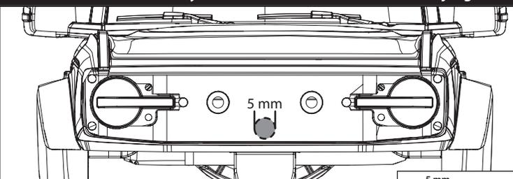
**A4.** Utilice un escariador de carrocería cónico para cortar cuidadosamente un agujero de 5 mm en el centro de la parte delantera de la carrocería, tal como se muestra.
