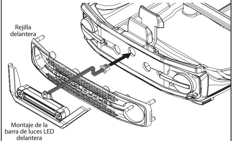
**A6.** Vuelva a montar la rejilla delantera. Asegúrese de que no haya cables aprisionados entre la carrocería del vehículo y la rejilla delantera antes de apretar los tornillos.
