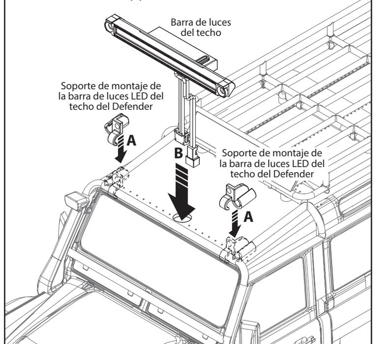
**B5. Fije la barra de luces de techo a los soportes de montaje.**
