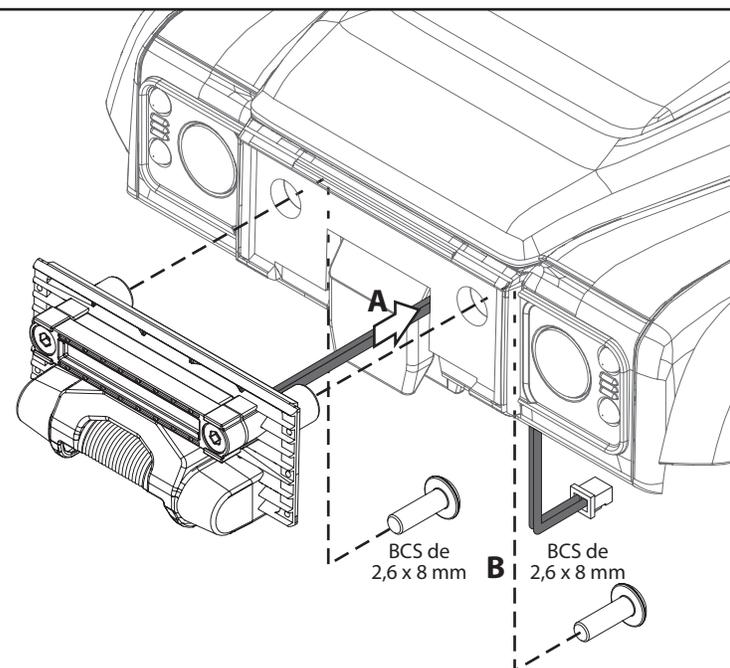
**A4.** Pase el arnés de la barra de luces LED delantera por la ranura situada entre el pestillo de la carrocería y la carrocería de la camioneta (A).
