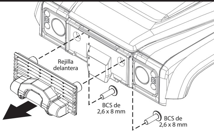
**A1.** Retire la rejilla delantera existente de la carrocería. *Conserve y reutilice los tornillos.*
