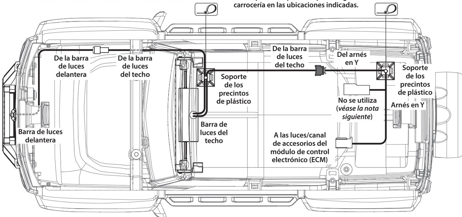
*Nota: Si el juego de luces de carrocería n.º 9783 se ha instalado previamente en la carrocería, enchufe el conector n.º 9783 en el arnés en Y incluido.*
