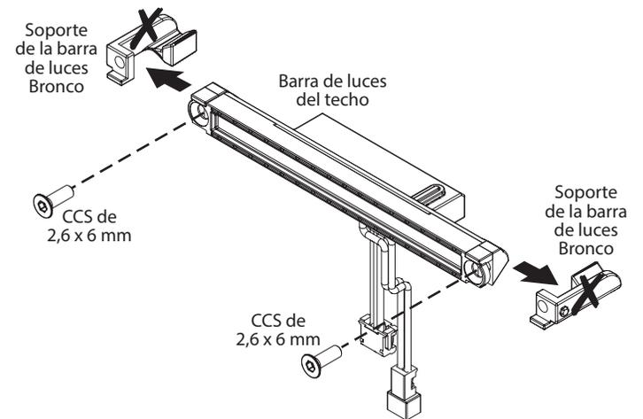
**B3.** Encaje los soportes de montaje izquierdo y derecho de la barra de luces de techo en la jaula ExoCage (A).
