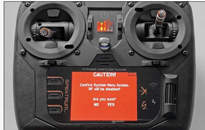
NX10 je standardně dodáván v módu 2, takže mnoho uživatelů bude hned zkrájet řešit jeho přepnutí do módu 1, tedy s plynem vpravo. Změnu módu musíme nejprve nastavit v menu a následuje chvíli práce s křížovým šroubovkem, kterým povolujeme
