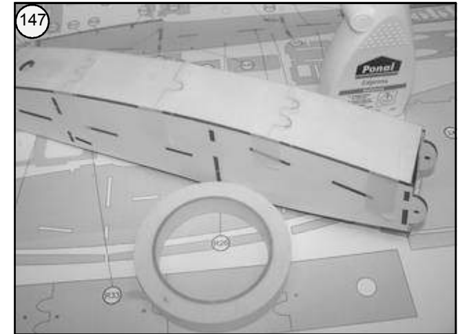
Bild 147 - Bodenbeplankung auf die Unterseite des Rumpfes kleben, mit Krepfstreifen bis zum Durchtrocknen verspannen.
