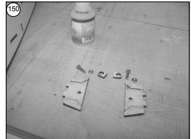
Bild 150 - Gewindeschrauben und Muttern selektieren.
