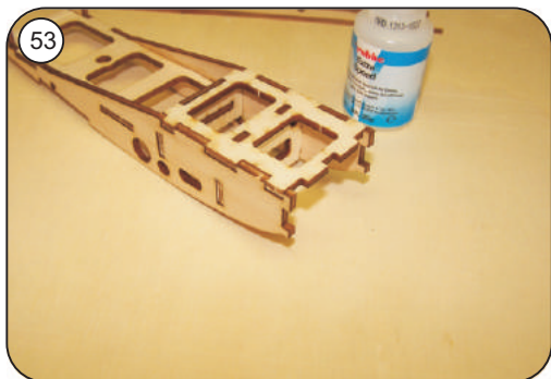
53 Boden unten M 5 einsetzen und anheften
