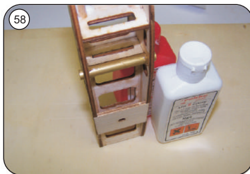
58 Steckungsrohr M 9 mit Epoxy einharzen
