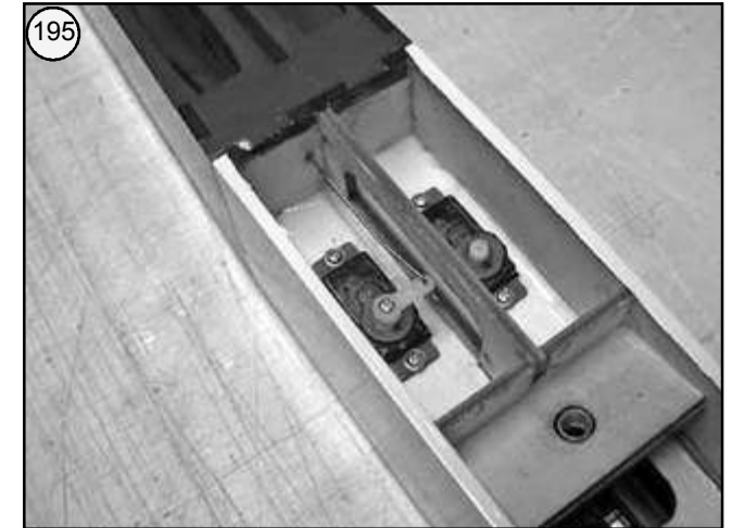
Bild 189 - Servos mit der Fernsteuerung auf den Nullpunkt einstellen. - Servohebel aufsetzen und mit der Befestigungsschraube in der Servoachse festschrauben.
