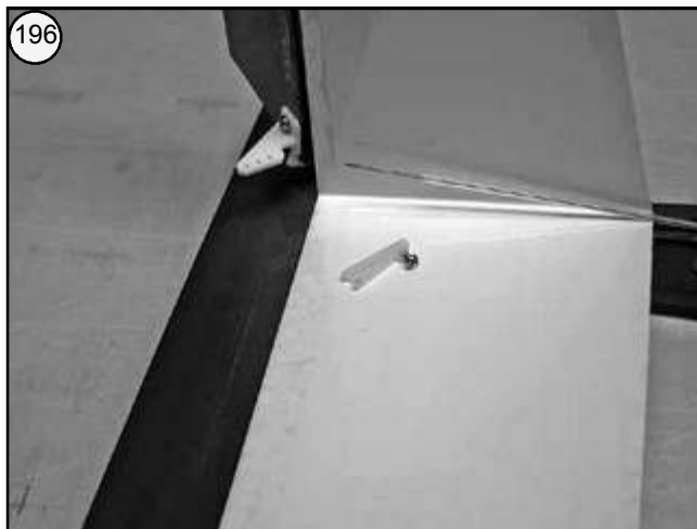
Bild 196 - Gestänge am Ende auf entsprechende Länge abschneiden, Länge des Gabelkopfes dabei berücksichtigen.
