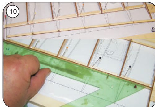
10 Querruder-Anschlag F 18 einkleben und gerade ausrichten
