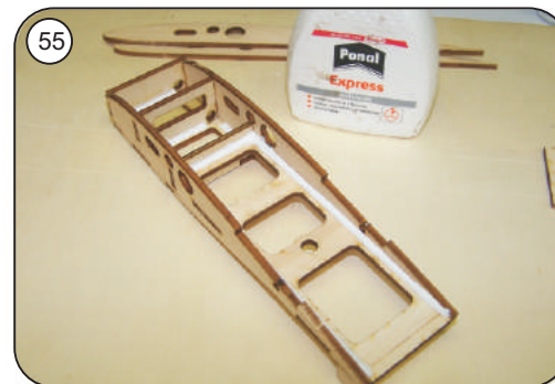
55 Alle Klebstellen nachträglich satt mit Holzleim vermuffen
