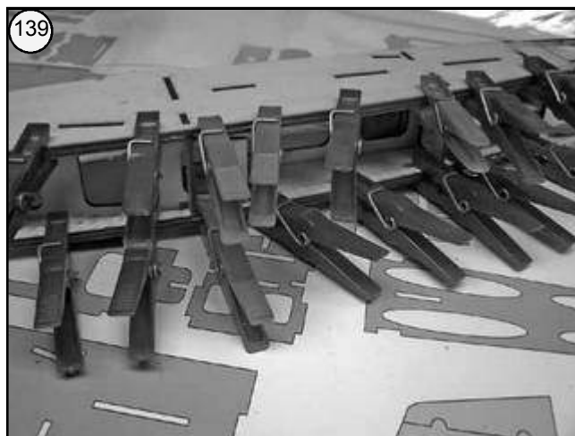
Bild 139 - Restliche Rumpfgurte R 25 - R 27 einkleben.
