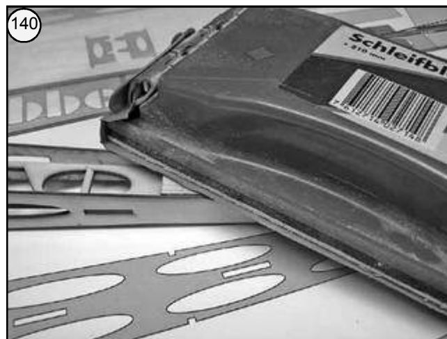
Bild 140 - Den gesamten Rumpfröhbau mit feinem Schleifpapier überschleifen.
