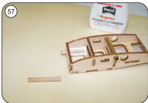
57 Steckungsdübel M 8 einkleben, auf gute Verklebung achten !
