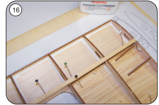
Alle Klebestellen von F 1 mit Holzleim nachkleben
