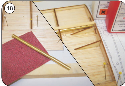
Steckrohr F 23 mit Schleifpapier anrauen und mit Epoxyleber einkleben
