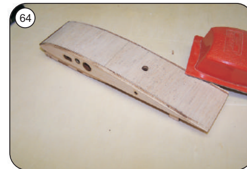
64 Mittelstück sauber verschleifen
