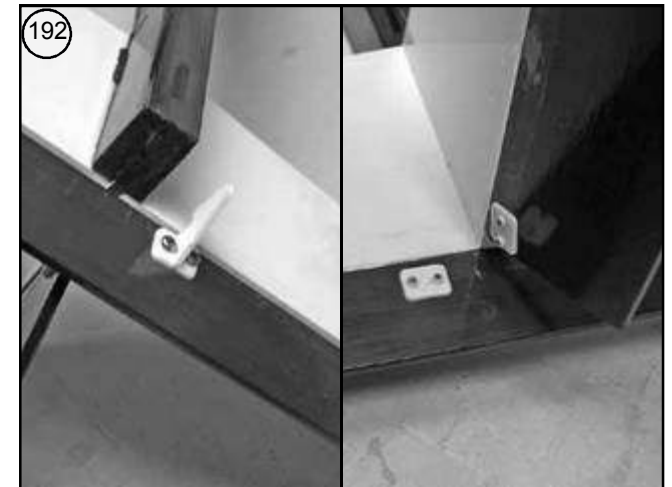
Bild 192 - Ruderhorn am Höhenruder anschrauben.
