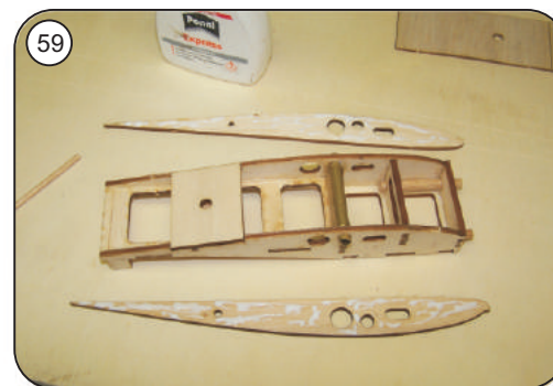
59 Abschlussrippen M10 mit Buchendübel am Mittelstück ausrichten und verkleben
