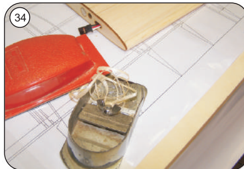
Beplankungen und Nasenleiste sauber verschleifen
