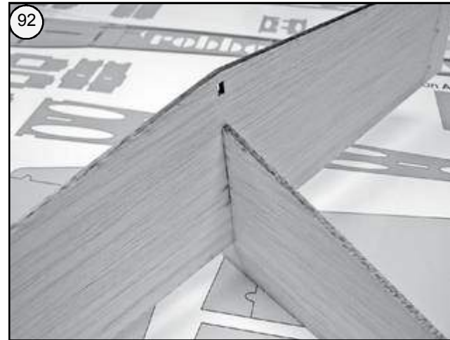
Bild 92 - Unter den Leitwerken ein Stück Klarsichtfolie auf das Baubrett legen. - Die Leitwerke ineinanderschieben, bis sie einrasten.
