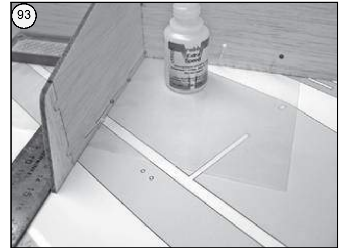
Bild 93 - Zusammengesteckte Leitwerke mit einem Winkel 90° zueinander ausrichten und mit Sekundenkleber verkleben.
