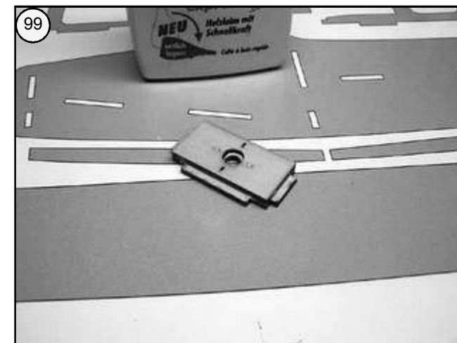
Bild 99 - Auf deckungsgleiche Bohrungen und bündig verlaufende Kanten achten.
