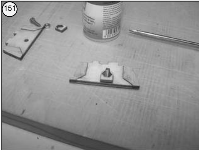
Bild 151 - Muttern mit Schrauben in Mt 1 eindrehen, Mutterhalter Mt 4 ausrichten und aufkleben.
