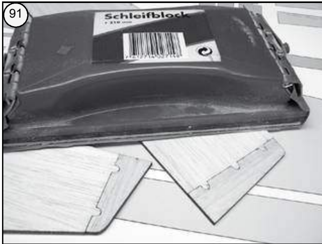
Bild 91 - Leitwerke, insbesondere die Klebestellen mit feinem Schleifpapier überschleifen.
