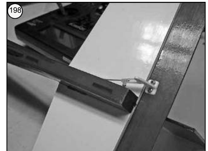
Bild 198 - Höhenruder in der gleichen Weise anlenken.
