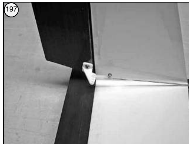
Bild 197 - Gabelkopf auf das Gestänge aufschieben und in das Ruderhorn einhängen. Ruder auf Neutral stellen und den Gabelkopf festschrauben.
