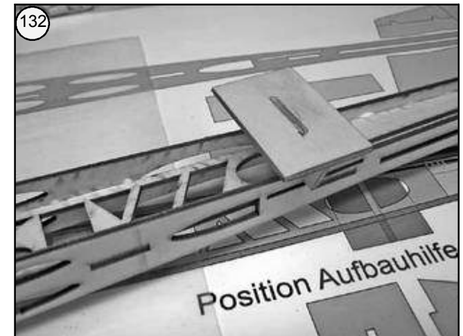
Bild 132 - Rumpf vom Baubrett lösen und umwenden.
