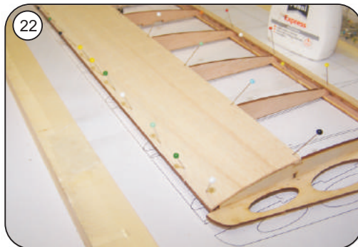
Beplankung bis zum Durchtrocknen mit Stecknadeln fixieren
