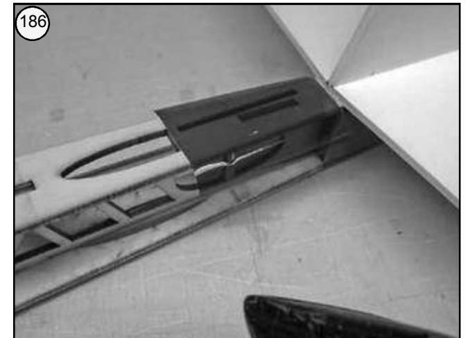
Bild 186 - Hinteres Rumpfteil bespannen und Öffnung für Seitenrudergestänge freilegen.
