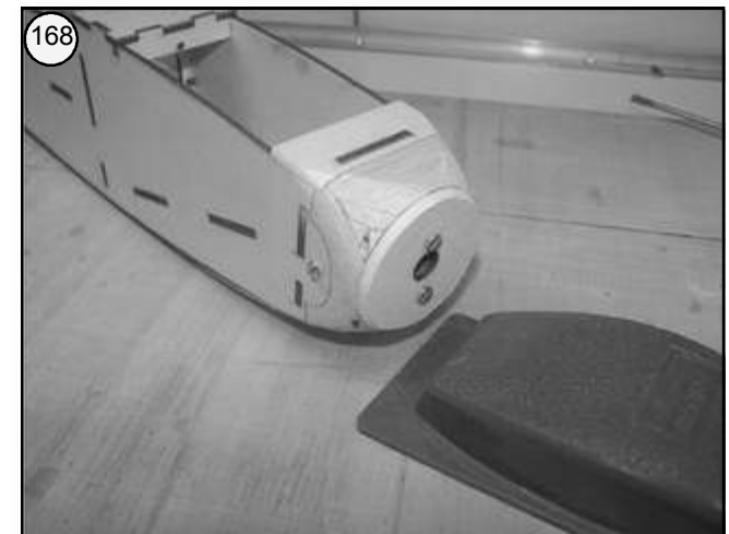
Bilder 167 und 168 - Hilfsspann MT 13 am Motorspant anschrauben und den Rumpfkopf mit Schleifklotz und feinem Schleifpapier verrunden. Hilfsspann MT 13 dient dabei als Schleifanschlag.
