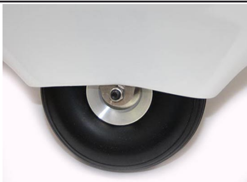
MDM-1 Fox přistává na podvozkové kolo o průměru 100mm.
