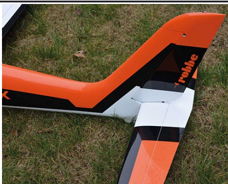
Výškovka se připevní dvěma šrouby na přesnou pozici s vlepěnými maticemi.
