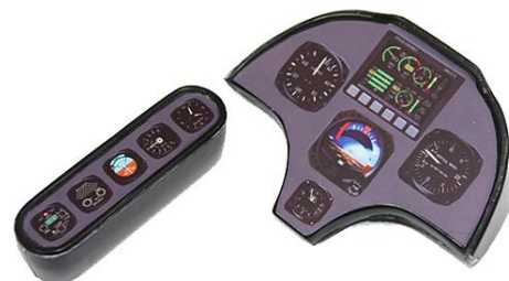
Fox má dvě desky přístrojů, jedna je před předním pilotem, druhá pro zadního pilota.
