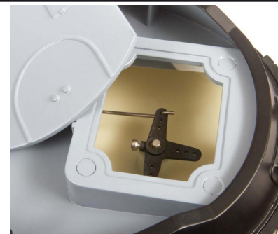
Pro přesné a funkční řízení směru jízdy, je v trupu lodi nainstalováno silné voděodolné servo s kovovými převody.
