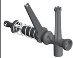
A. Tighten/Loosen Upper Cap
