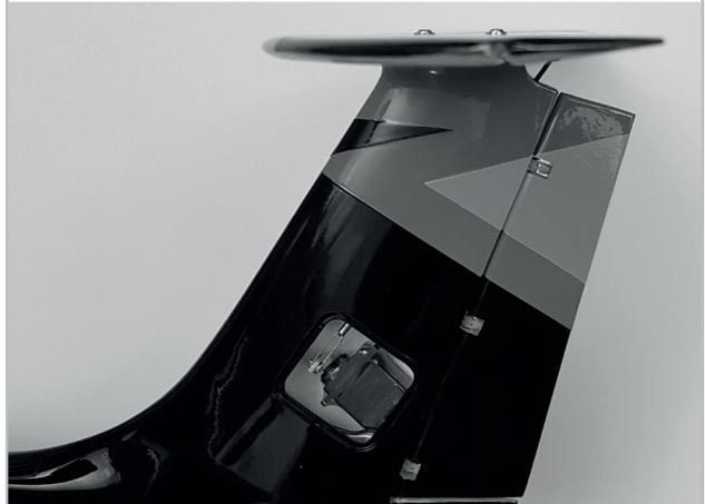
Kontrollieren Sie die Länge des Höhenrudergestänges und korrigieren Sie diese ggf. am Gabelkopf. Das Ruder sollte sich bei 90° Servoarm-Stellung in Neutrallage befinden.
