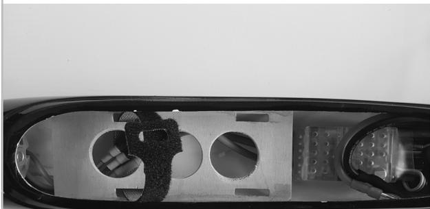
Schliessen Sie Ihren Regler nun an die drei Motorkabel, sowie an dem entsprechenden Ausgang des Empfängers an und überprüfen Sie die richtige Laufrichtung (in Flugrichtung im Uhrzeigersinn) des Motors. Sollte der Motor falsch herum drehen, tauschen Sie lediglich zwei der drei Motorkabel. Befestigen Sie den Regler auf der Unterseite des Rumpfes hinter dem Akkubrett mit Klett oder durch Klemmen mit Schaumstoff. Sichern Sie ggf. die Kabel, so dass diese nicht in den Motor geraten können!
