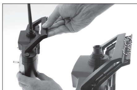
3. Separare delicatamente le due metà della scatola della trasmittente
