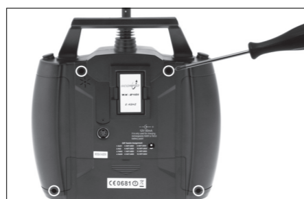
2. Per aprire la trasmittente, svitare e togliere le quattro viti che si trovano sul retro.
