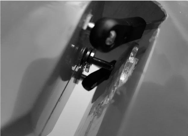
Legen Sie nun das Drucklager auf den Führungstift des Seitenruders und fädeln es in die Aufnahme des Rumpfes ein. Die Seile hängen nun in den Rumpf hinein. Es hat sich bewährt, bei diesem Vorgang den Rumpf 90° auf die Seite zu legen.
