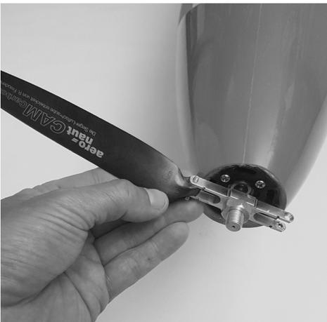
Danach werden auch die Luftschraubenblätter und die Spinnerkappe am Mittelteil montiert.
