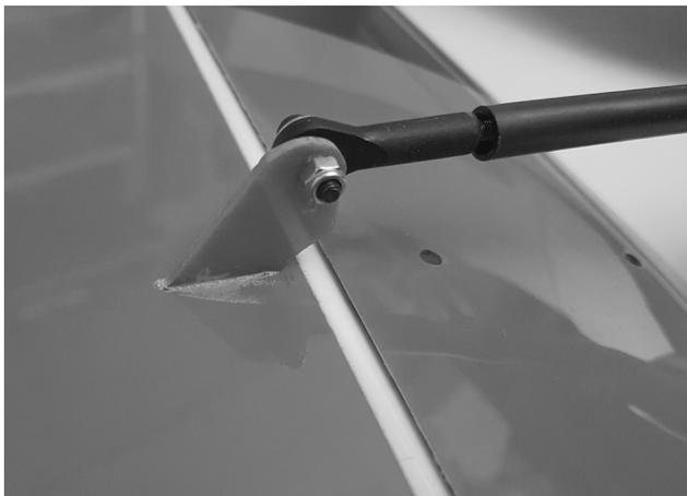
Schrauben Sie in die äußere Bohrung des Ruderhorns den M3 Kugelbolzen. Stecken Sie den Kugelkopf des Höhenruder Gestänges auf den Kugelbolzen.
