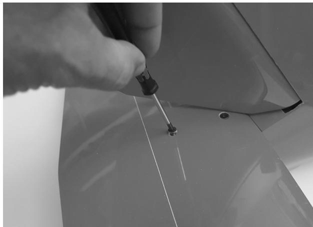
Fädeln Sie das Gestänge hinten in den Rumpf ein und schrauben Sie das Höhenruder mit den M4 Senkschrauben am Rumpf fest.
