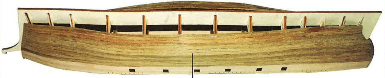
Listelli tiglio - Lime wood strips - Lindenholzleisten - Listeaux en tilleul - Strips in lindehout - Listones de cal 1x3x460 mm
