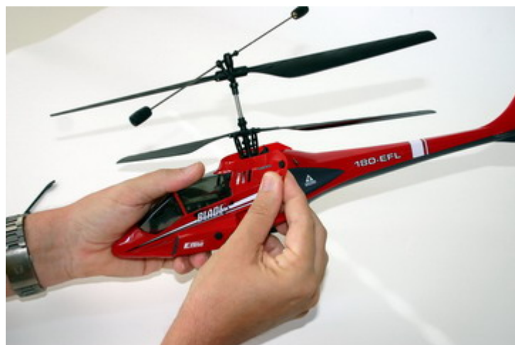
3. Přední díl karosérie demontujete tak, že nejdrive vysuňte zadní část gumových průchodek z uhlíkové tyčinky a teprve poté průchodky z přední tyčinky.
