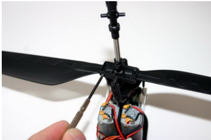
11. Demontujte dva šrouby, držící spodní rotorové listy
