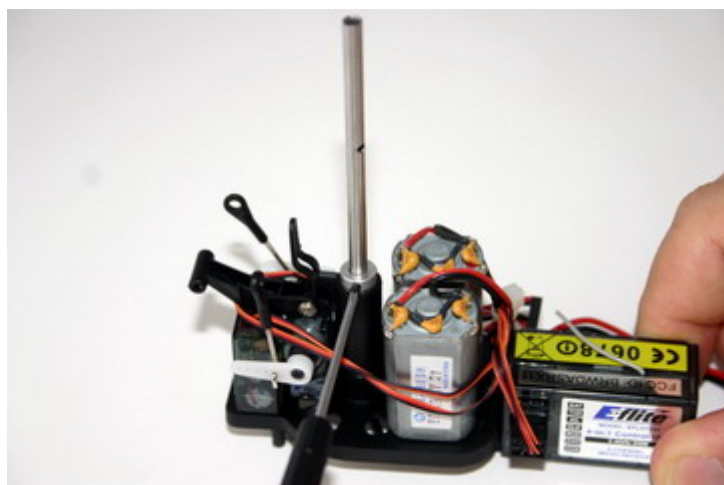
20. Vnější hřídel je jištěna červíkem na pojišťovacím kroužku na vnější hřídeli který povolíte a kroužek z hřídele stáhnete.
