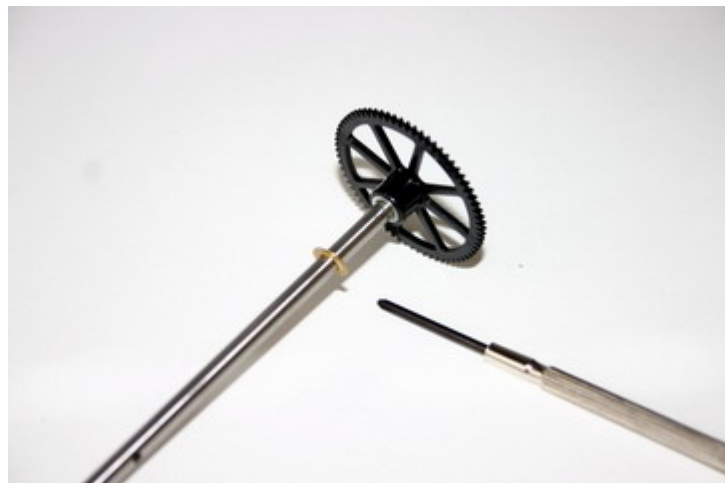
23. Pozor, na vnější hřídeli je podložka, která je distancí mezi kolem a ložiskem.
