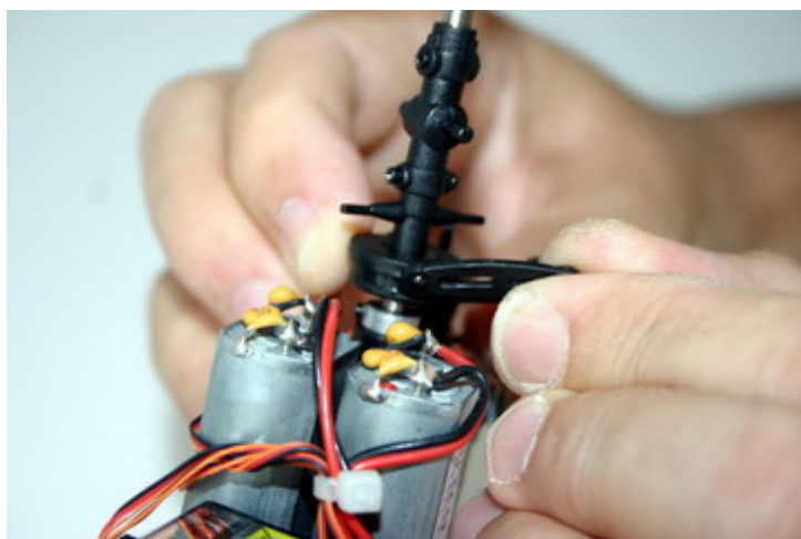
13. Táhla vyjměte mírným vykloněním z čepů desky cyklíky.
