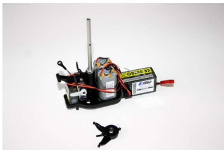
19. Stáhněte táhla serv z kulových čepů desky cykly. Nyní je deska cykly volná a můžete ji stáhnout z hřídele.
