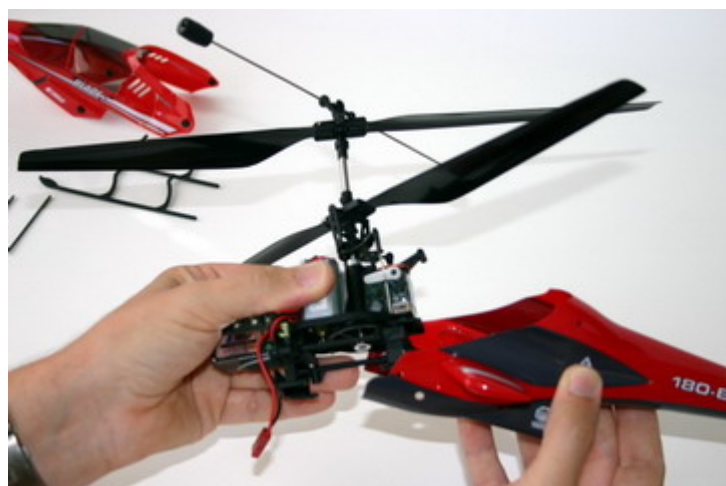
4. Vytáhněte uhlíkové tyčinky ze zadní části karosérie a odsuňte karosérii dozadu.
