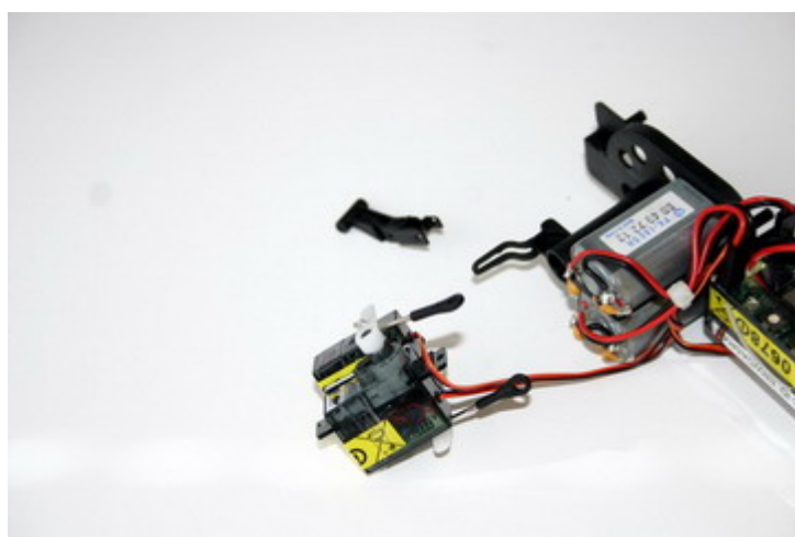
28. Demontáž serv provedete odpojením konektorů, rozlepením oboustranné fólie a demontáží pák serv.
