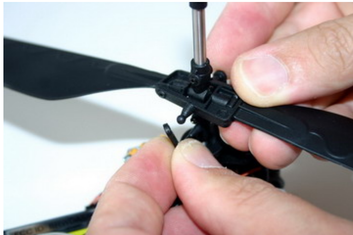
12. Vysuňte kupové čepy z listů spodního rotoru a poté listy vyjměte stejným způsobem jako u vrchních listů.
