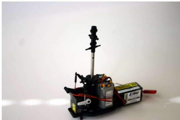
18. Stáhněte rotorovou hlavu z vnější hřídele.
