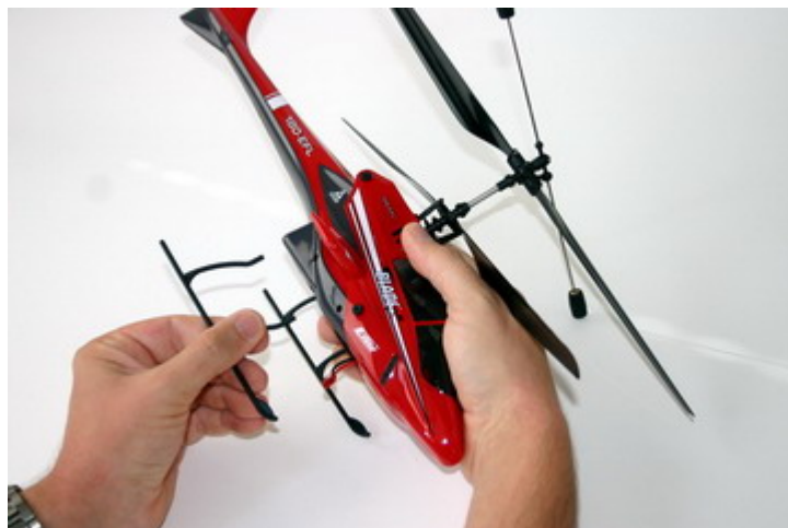
2. Vytáhněte podvozkové lyžiny z držáků kostry vrtulníku, podvozek je v držáku pouze nasunutý, je nutno jej opatrně vytáhnout.
