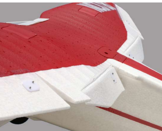
Volitelně lze nainstalovat vztlačové klapky, pozice a uvožení serva jsou hotovy
