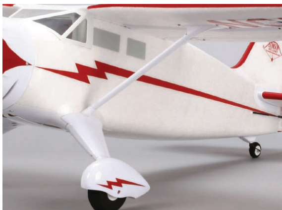
Aerodynamické tvarování podvozku a vzpěr křídla neskutečně přispívají vzhledu modelu
