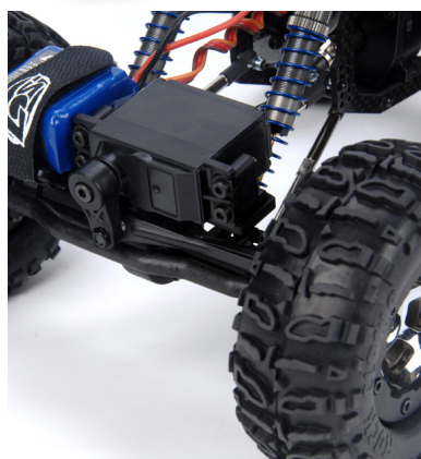
Přímá zátěž přední nápravy je zajištěna montáží serva a baterie
