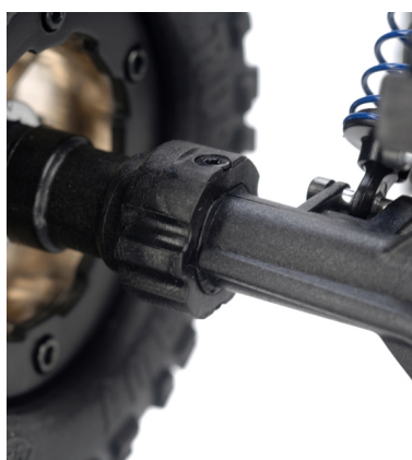
Jednoduchá tuhá zadní náprava lépe přenáší vysoké zatížení a optimálně zvyšuje přenos síly na kola
