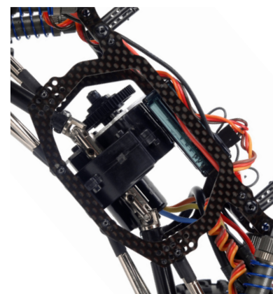
Nízká hmotnost podvozku je zárukou potřebné koncentrace hmotnosti na nápravě a zlepšení stability
