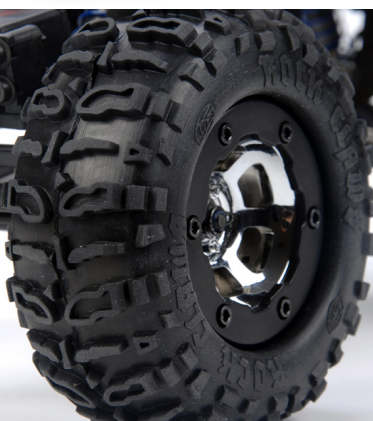
Speciální pneumatiky Mini Rock Claw pro vysokou přilnavost a záběr
