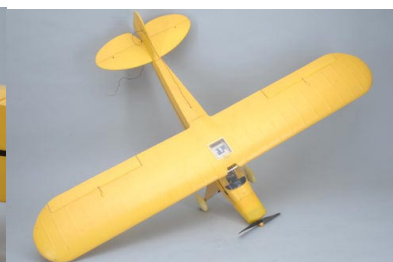
Sestavený model známého letounu Piper J-3 Cub s nainstalovanými servy, motorem a regulátorem.
