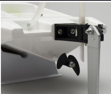
Hliníkové kormidlo má bezpečnostní pojistku při najetí na překážku se ustříhne kolík a kormidlo se sklopí dozadu.
