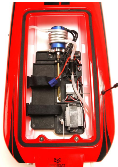
kompletně sestaven s nainstalovanou 2 kanálovou RC soupravou 2,4GHz a 2 kanálovým vodě odolným přijímačem
